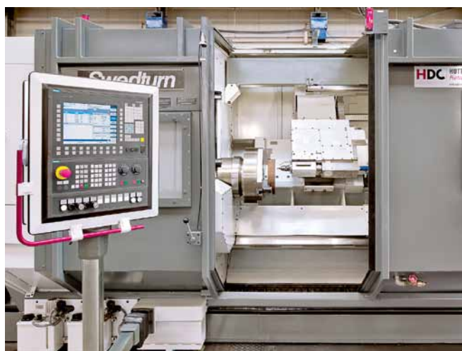
Wiederinbetriebnahme: Probebearbeitung mit Transmit-Funktion und eingekoppeltem Antrieb für einen eingewechselten Fräser.
