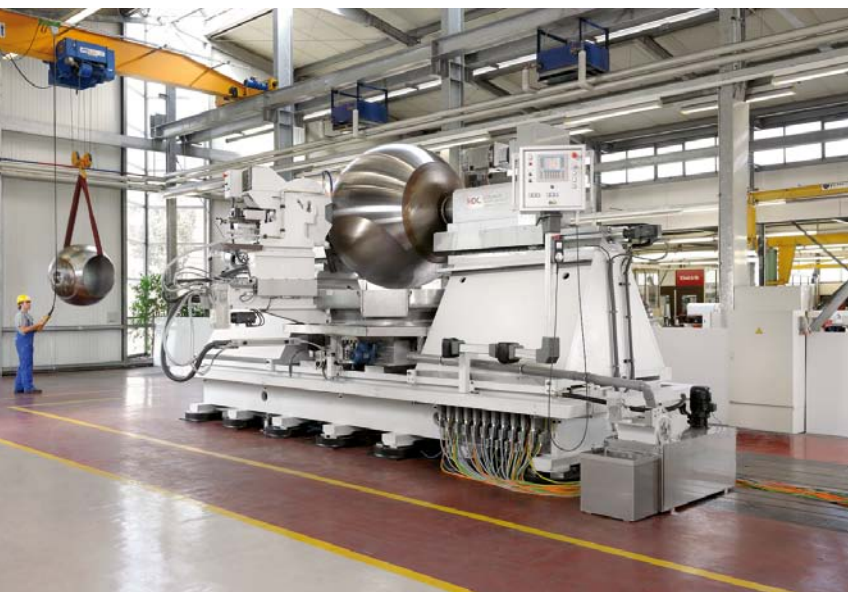
Bild 1: KDSM 1400 für Kugelaußendurchmesser von 1.200 bis 2.010 mm
