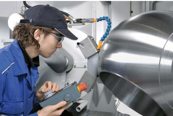
Bild 3: Ortsvariables Bedienpanel für den manuellen Betrieb und Einrichtarbeiten
