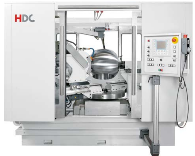
Bild 2: KDSM 300 für Kugelaußendurchmesser von 76,5 bis 500 mm
