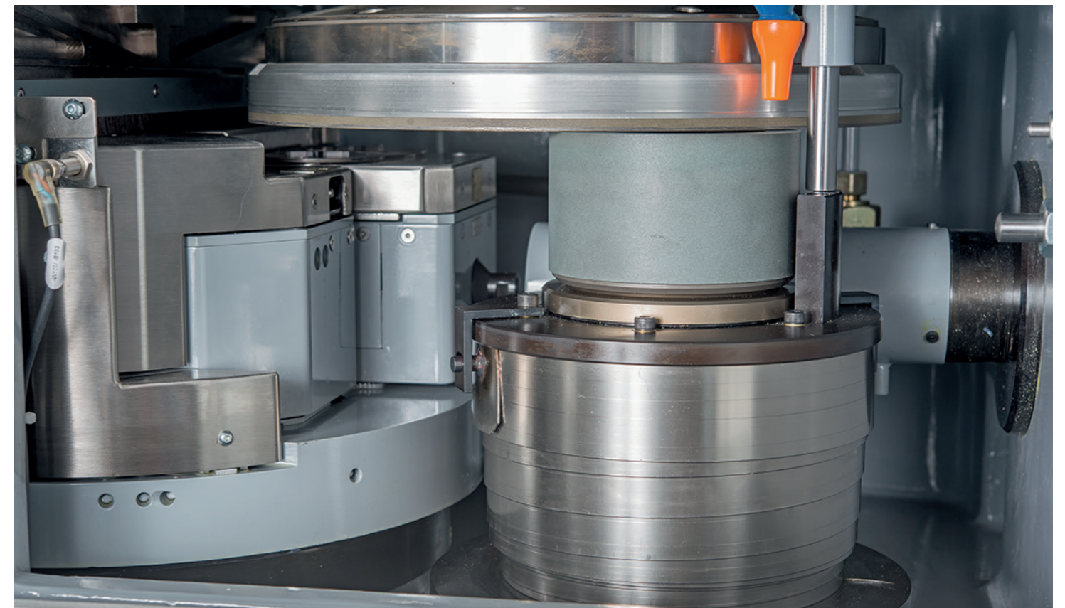
2 Das integrierte Abrichtgerät „Rotodress“ konditioniert die Schleifscheibe während der Bearbeitung (Bild Huttelmaier)
