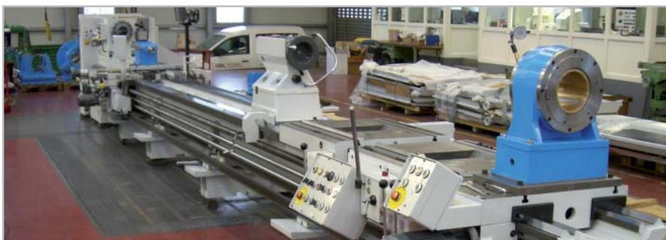
Erneuerung des Schaltschranks, der Außenverdrahtung und Neugestaltung aller Bedienelemente
